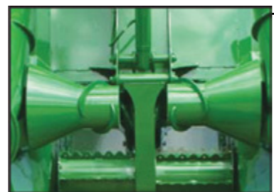
مکان نصب غلطکهای (CKD) برای هدایت بهتر نیشکر به طرف مرکز دستگاه و تغذیه مناسب تر دستگاه در حین کار
