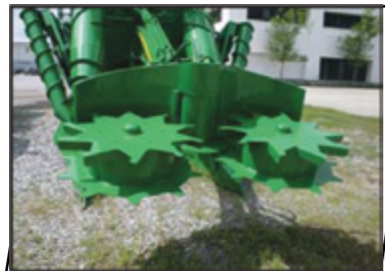
تایپر استاندارد با قابلیت سرزنی نیشکر تا ارتفاع بیش از ۵ متر و عرض کار مناسب
