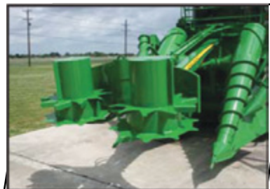
مکان نصب تایپر اصلاح شده برای افزایش کارایی تایپر استاندارد در شرایط سخت کاری
