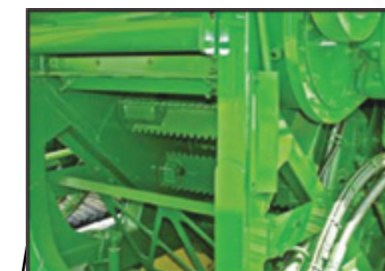
نصب غلطک های تغذیه ( feed rollers ) با طراحی جدید (پاروئی) برای کاهش تجمع گل و لای روی غلطک
