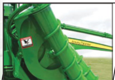
نصب چاقوهای جانبی در موقعیت مناسب برای افزایش کارایی در مزارع نیشکر در هم تنیده
