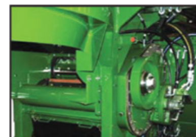
نصب هیدروموتور پیستونی فشارقوی برای گیربکس چاپر و نصب غلطک انتهایی برای سهولت حرکت قطعات ریز نیشکر درون سبد برالواتور
