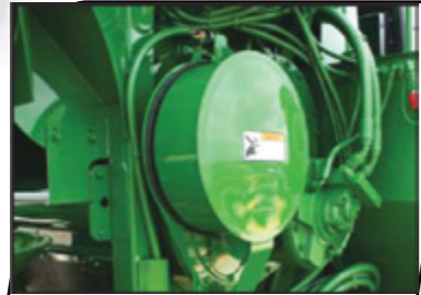
نصب محافظ روی فلاپویل چاپر برای افزایش ایمنی اپراتور
