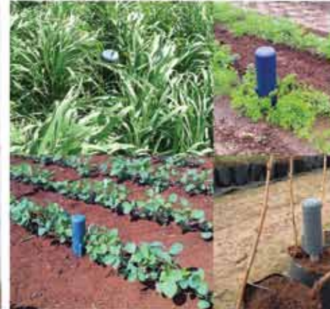
نماینده انحصاری Aquacheck در ایران: دستگاه سنجش رطوبت و دمای خاک تا عمق ۱۵۰ سانتیمتر و کنترل آبیاری از طریق اینترنت و از راه دور
