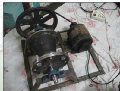
شکل (۲) آسیاب گلوله ای جهت آسیاب خاکستر باگاس
