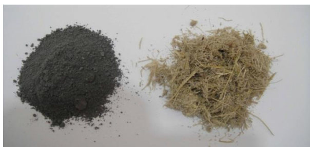
شکل (۵) باگاس و خاکستر باگاس آسیاب شده
