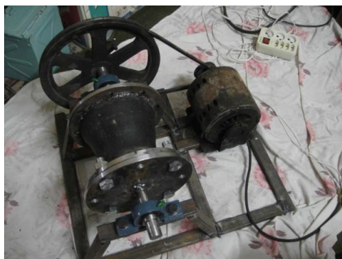
شکل (۲) آسیاب گلوله ای جهت آسیاب خاکستر باگاس
