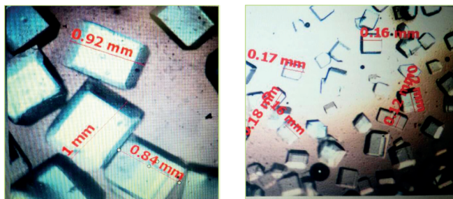
شکل ۳- اندازه کریستال در ابتدای عملیات طبخ (تصویر سمت راست) و در انتهای عملیات (تصویر سمت چپ)
