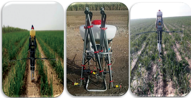
شکل ۲- سمپاش پشتی میکرو نر و نحوه استفاده از آن
