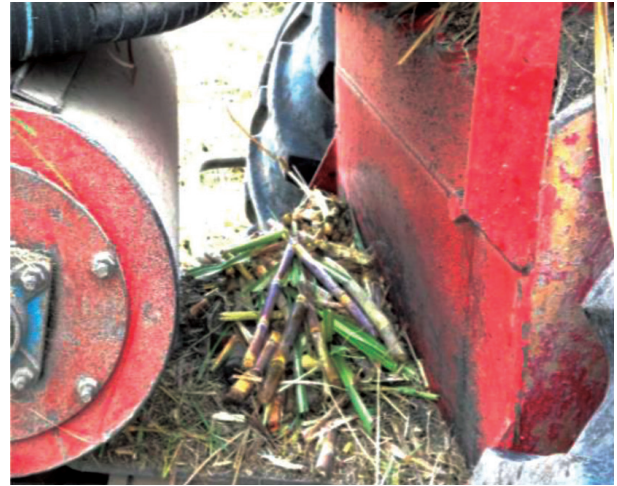
شکل ۳- افتادن نی‌های قلمه شده به داخل مزرعه از زیر صفحه رگلاژشونده هدایت کننده نی به داخل سبد الواتور
