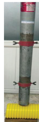
شکل ۸- انجام آزمون ضربه نمونه لوله زهکش نگهداری شده داخل آزمایشگاه
