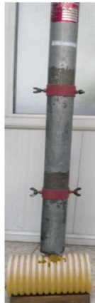
شکل ۹- آزمون ضربه نمونه لوله زهکش نگهداری شده در معرض نور خورشید
