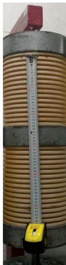
شکل ۷- آزمون کشش نمونه لوله زهکش نگهداری شده در معرض نور خورشید
