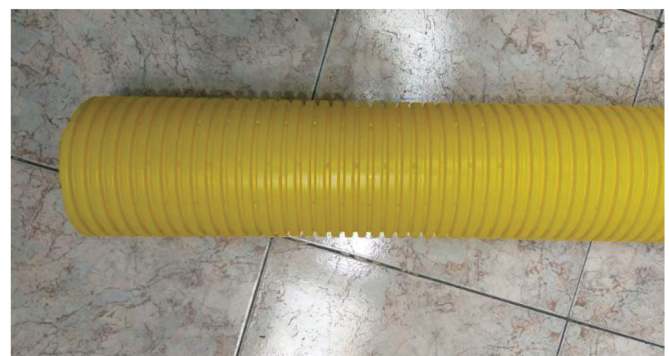
شکل ۲- وضعیت ظاهری نمونه لوله زهکش نگهداری شده داخل آزمایشگاه
