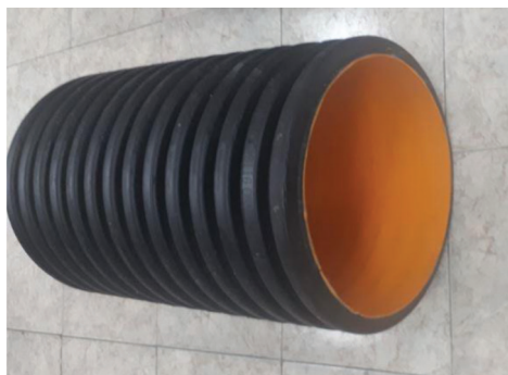
شکل ۹- وضعیت ظاهری نمونه لوله پلی اتیلن نگهداری شده در آزمایشگاه
