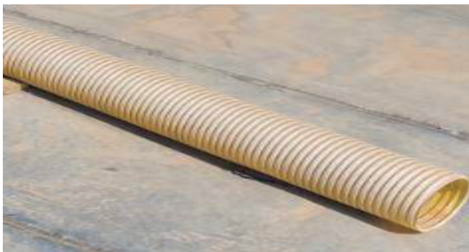
شکل ۳- وضعیت ظاهری نمونه لوله زهکش نگهداری شده در معرض نور خورشید
