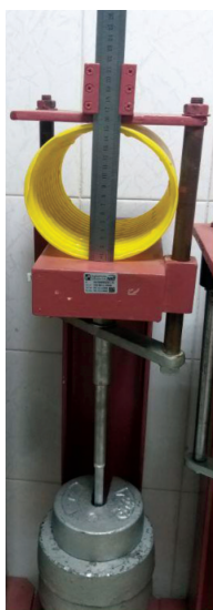
شکل ۴- انجام آزمون دوپهن شدن نمونه لوله زهکش نگهداری شده داخل آزمایشگاه
