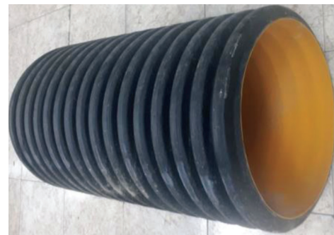
شکل ۸- وضعیت ظاهری نمونه لوله پلی اتیلن نگهداری شده در معرض نور خورشید
