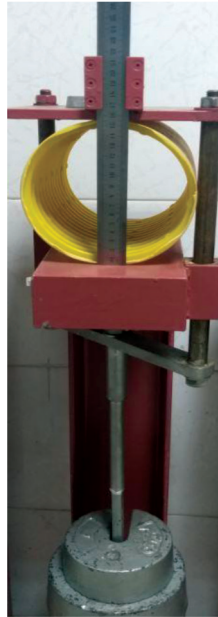
شکل ۵- انجام آزمون دوپهن شدن نمونه لوله زهکش نگهداری شده در معرض نور خورشید
