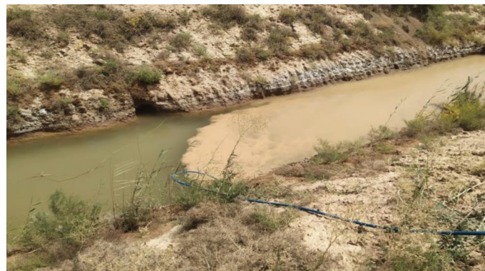
شکل ۵- حجم رسوب خروجی از لترال هنگام فلشینگ جت
