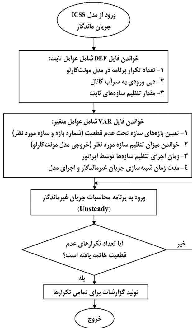
شکل ۱- نمودار گردش مراحل شبیه‌سازی مدل مونت کارلو در تلفیق با مدل ICSS
