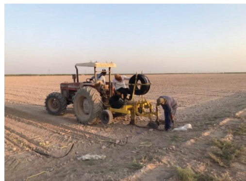
شکل ۱- لوله‌گذاری با استفاده از دستگاه لوله‌گذار آبیاری قطره‌ای زیرسطحی و کنترل عمق کارگذاری لوله
