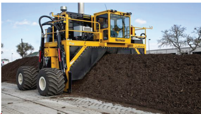
شکل ۱۱- فرایند هوادهی و به هم زدن ریشه‌های کمپوست به کمک ترنرهای مختلف
