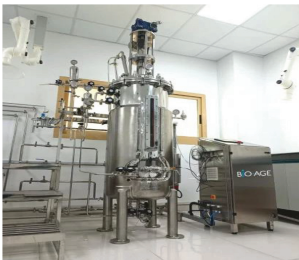
شکل ۵- نمونه یک فرمانتور ۲۵۰ لیتری برای تولید عوامل میکروبی
