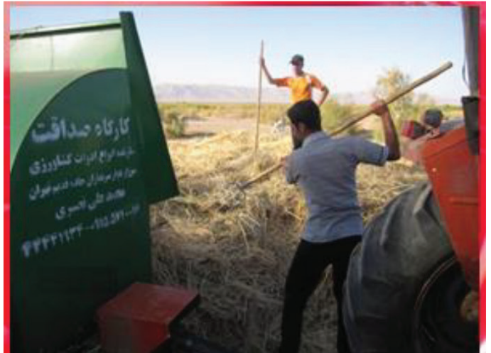
شکل ۶- نمایی از یک خرمنکوب معمولی برای خرد کردن سرشاخه و یا پوشال نیشکر
